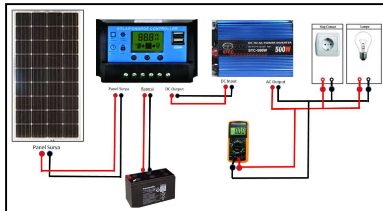
Gambar 2. Skema Pemodelan Alat Praktikum PLTS
