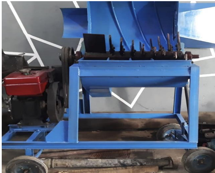
Gambar 2. Mesin pencacah sampah organik
