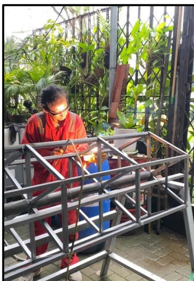
Gambar 2. Desain dan Pabrikasi Alat Pengering Kopi Hexagonal Rotary Dryer
