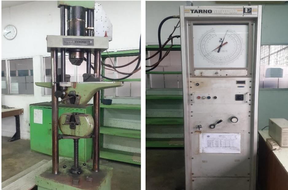
**Gambar 2.** Mesin Uji Tarik
