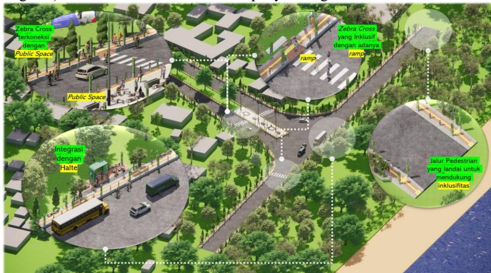
**Gambar 4.** Ilustrasi kelengkapan komponen jalur pedestrian menuju pantai barat dan timur Pangandaran
