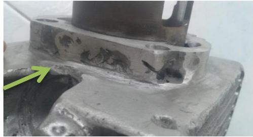
Cacat pada rongga udara pada blok silinder
